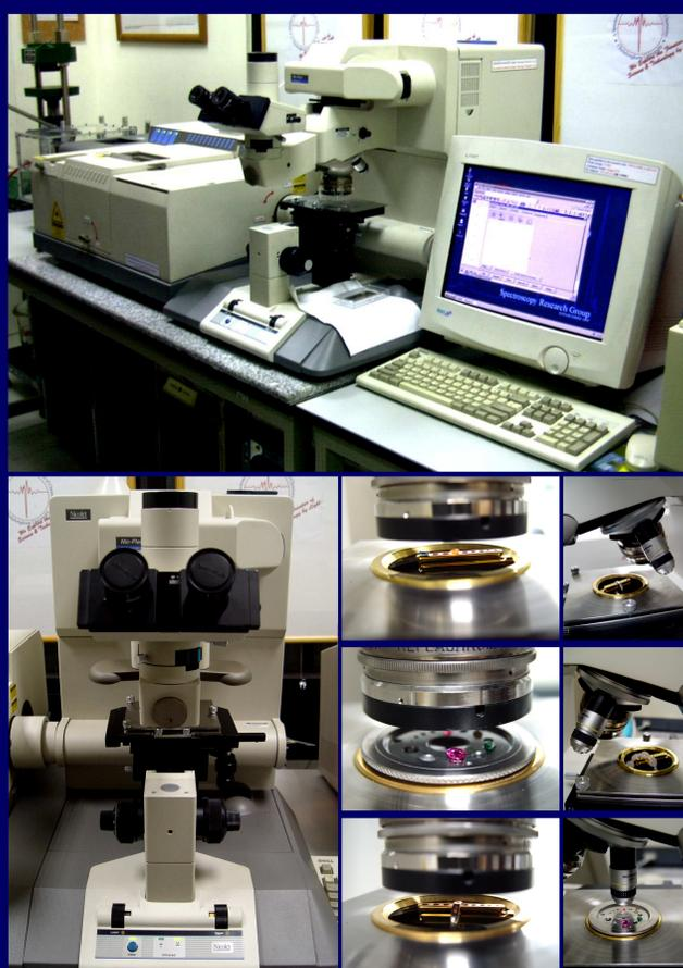
รูปที่ 1 Nicolet Magna 750 FT-IR spectrometer, NICPLAN Infrared Microscope และอุปกรณ์สำหรับวิเคราะห์อัญมณีที่พัฒนาขึ้นโดยคณะผู้วิจัยของหน่วยวิจัย Sensor Research Unit จุฬาลงกรณ์มหาวิทยาลัย
